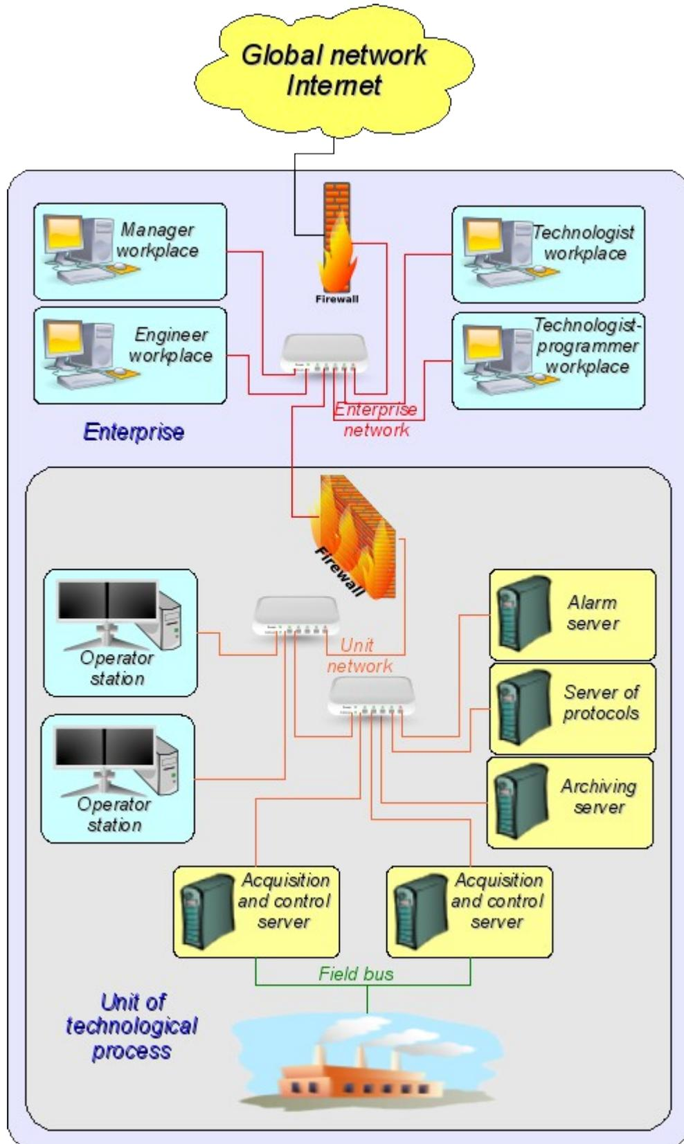
Fig. 2. SCADA-system.
